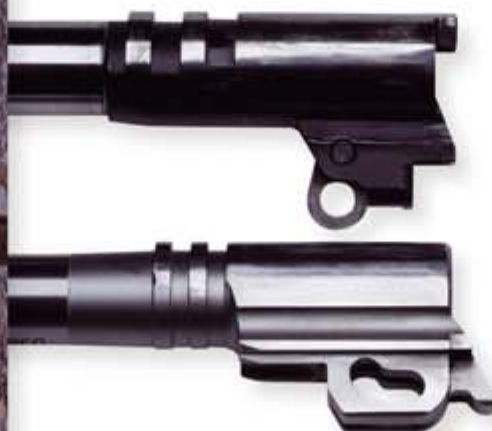
Kampf der Systeme: Beide Großkalibersportpistolen basieren auf Browning-Systemen mit abkippendem Lauf und zwei Verriegelungswarzen. Doch während die 1911-A1 ein bewegliches Kettenglied als Steuerelement besitzt (oben), weist die P210 eine geschlossene Steuerkurve auf.
