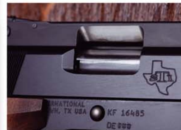
Feinheiten: Bei der Hamann 1911 wurde die Visierschiene im Bereich des Auswurf Fensters weiter ausgefräst, um einen sicheren Auswurf zu gewährleisten.
